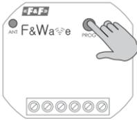
Nach korrektem Anschluss des Empfängers drücken und halten Sie die PROG-Taste, bis das Gerät den Ausgangskreis einschaltet und die Kommunikationsdiode erlischt.
