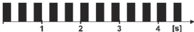
Signalisierung der Überschreitung der zulässigen Temperatur im Inneren des Sensors. Der Sensorbetrieb ist blockiert, bis der Fehler behoben wird.
