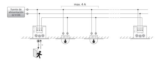
En caso de tener que controlar una carga superior a 4 A, hay que emplear amplificadores de señal LED-AMP-1P (montaje en la caja de instalación ø60) o LED-AMP-1D (montaje en carril DIN). Puede encontrar un ejemplo de esquema de conexiones en la página de subproducto en la página www.fif.com.pl.
