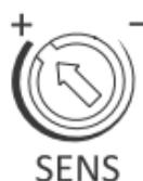
Der Erfassungsbereich des Bewegungsmelders kann von 1 m bis 10 m eingestellt werden (Parameter angegeben für einen Sensor, der in einer Höhe von 2,5 m installiert ist). Durch Drehen des Reglers im Uhrzeigersinn [+] wird der Erfassungsbereich erweitert, durch Drehen gegen den Uhrzeigersinn [-] verringert.
