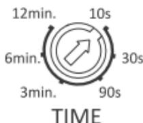
Die Einschaltzeit des Empfängers kann im Bereich von 5 Sek. bis 12 Min. eingestellt werden. Durch Drehen des Reglers im Uhrzeigersinn [+] wird die Einschaltzeit erhöht, durch Drehen gegen den Uhrzeigersinn [-] wird die Einschaltzeit verringert.
