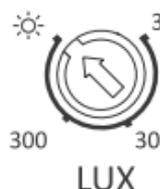
Die Empfindlichkeit des Dämmerungsschalters kann im Bereich von 2÷2000 lx eingestellt werden. Die Empfindlichkeit wird durch Drehen des Potentiometers in die gewünschte Richtung angepasst (Symbol Mond dunkler, Symbol Sonne heller). Damit der Sensor den ganzen Tag über aktiv ist, muss der Drehknopf maximal auf Symbol Sonne eingestellt werden.
