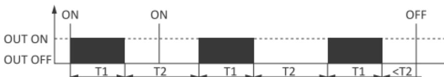
Die Zyklenausführung der Vorgänge OUT ON (Relais einschalten) für die Zeit  $T_1$  und OUT OFF (Relais ausschalten) für die Zeit  $T_2$ . Der Zyklus wird durch das Senden des ON-Befehls ausgelöst. Die Anzahl der ausgeführten Zyklen hängt vom Registerwert 0x235 ab. Wenn
