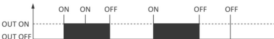
Der Standardbetriebsmodus des Moduls, bei dem der Ausgang direkt mit Modbus-Befehlen ein- und ausgeschaltet wird.
