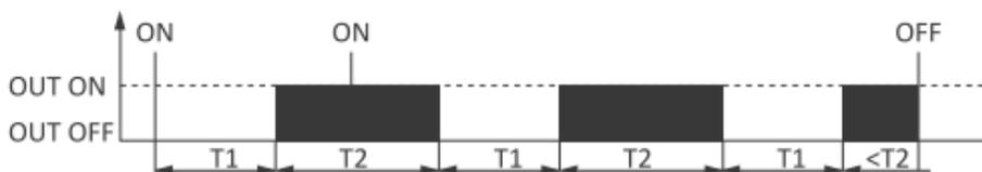
Ciclo di funzionamento OUT OFF (relè spento) per il tempo  $T_1$  e OUT ON (relè acceso) per il tempo  $T_2$ . Il ciclo viene attivato con l'invio del comando ON. Il numero di cicli eseguiti dipende dall'impostazione del registro 0x235. Se questo registro è impostato a 0, il programma verrà eseguito ciclicamente fino all'invio del comando OFF.
