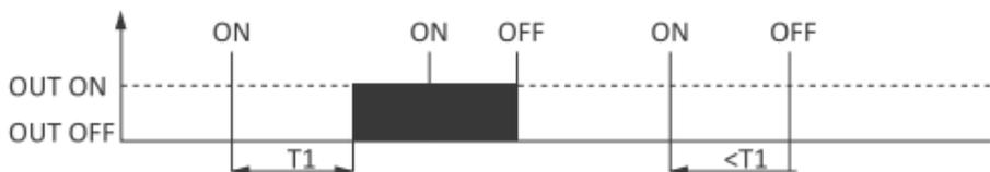
Alla ricezione del comando ON, il controllore esegue il tempo di conteggio impostato nel parametro T1 e attiva il relè. Lo spegnimento del relè avviene dopo la ricezione del comando OFF. L'invio di un comando OFF durante l'intervallo di tempo T1 interrompe il ciclo. Un altro comando ON ricevuto al tempo T1 o quando il relè è già attivo viene ignorato.
