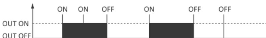
Modo di funzionamento predefinito del modulo in cui l'uscita viene attivata e disattivata direttamente tramite comandi inviati via Modbus.
