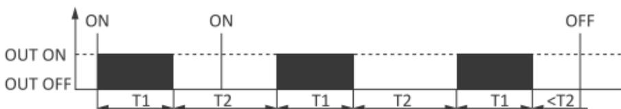
Esecuzione ciclica del funzionamento OUT ON (relè acceso) per il tempo T1 e OUT OFF (relè spento) per il tempo T2. Il ciclo viene attivato con l'invio del comando ON. Il numero di cicli eseguiti dipende dall'impostazione del registro 0x235. Se questo registro è impostato a 0, il programma verrà eseguito ciclicamente fino all'invio del comando OFF.
