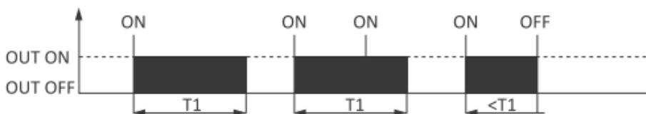
Dopo aver ricevuto il comando ON, il relè si accende e, trascorso il tempo impostato, si spegne. Allo scadere del tempo impostato, è possibile riavviare il ciclo inviando un altro comando ON. L'invio del comando OFF spegne il relè. Il comando ON ricevuto durante il conteggio del tempo T1 viene ignorato.
