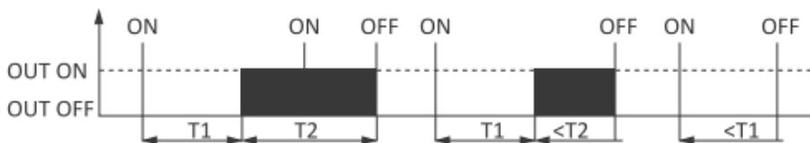
Dopo aver ricevuto il comando ON, il modulo registra il tempo  $T_1$ , quindi chiude il relè per il tempo  $T_2$ , seguito dallo spegnimento del relè.
