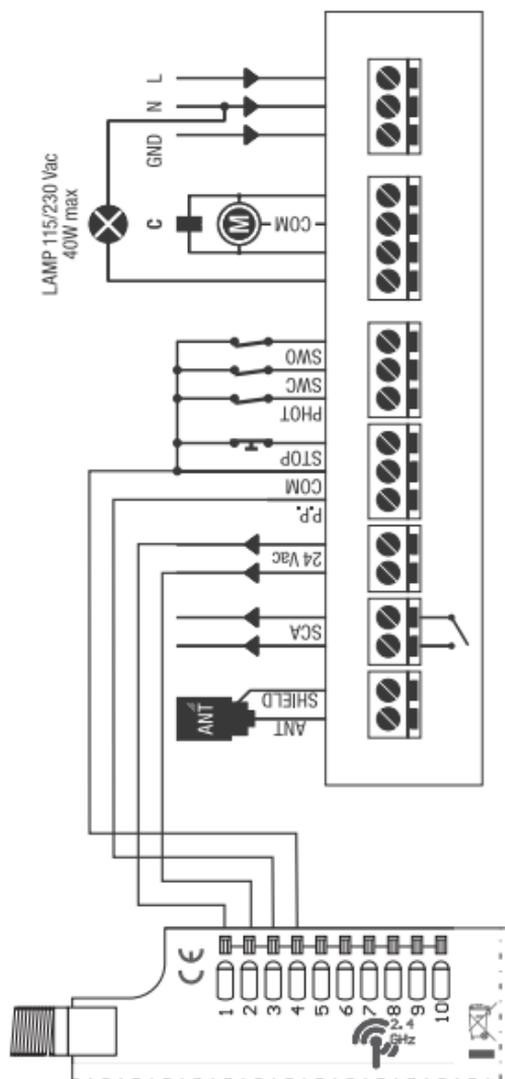
Esempio di collegamento al controllore Beninca Core
