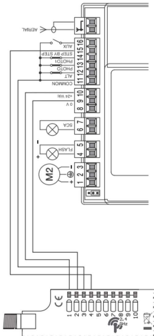
Esempio di collegamento al controllore Nice MC 424
