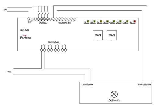
Wejścia - Inputs Wyjścia - Outputs Przekaźniki - Relays zasilanie - power supply sterowanie - control Odbiornik - Receiver
