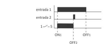
El tiempo de conexión del contacto establecido por un par de comandos **CONECTAR/DESCONECTAR** puede ser superior a 24 horas, es decir, el comando **CONECTAR [ON]** puede configurarse para cualquier hora y día de la semana (por ejemplo, martes, 13:45 horas) y el comando **DESCONECTAR [OFF]**, para cualquier hora del otro día de la semana (por ejemplo, jueves, 17:05 horas).
