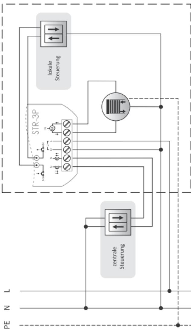
Kabel von der Steuerung STR-3P zum Motor: 3+PE
