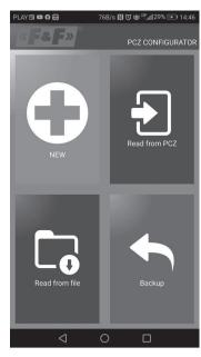
Das Funktionsfenster dient zur Programmbearbeitung und zum Auslesen und Speichern der Konfiguration in der PCZ-Steuerung. Sie erscheint automatisch, wenn Sie Ihr Smartphone der Steuerung annähern oder eine neue Konfiguration erstellen.
