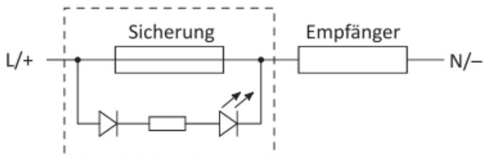
Internes Diagramm eines einzelnen Strompfads der Sicherung
