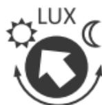
Die Empfindlichkeit des Dämmerungsschalters kann von 3 Lx bis 2000 Lx eingestellt werden. Wird der Regler in Richtung des Wertes 3 (min.) gedreht, bedeutet dies eine spätere Einschaltung der Beleuchtung, bei entgegen Drehung des Reglers in Richtung des Wertes 2000 (max.) eine frühere Einschaltung der Beleuchtung.
