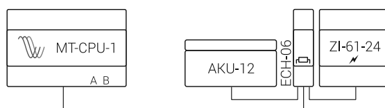
Przykład układu zasilania odbiornika 9÷30 V DC
