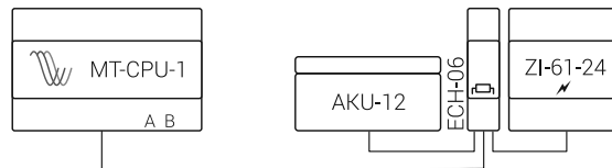
Przykład układu zasilania odbiornika 9÷30 V DC
