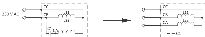
Typowy schemat silnika jednofazowego z kondensatorem rozruchowym
