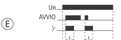
Generazione di un impulso singolo di tempo "t" con fronte crescente del segnale AVVIO. Durante la misurazione del tempo, il sistema non risponde agli impulsi di AVVIO.
