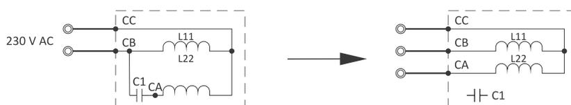
Schema tipico del motore monofase con condensatore di avviamento
