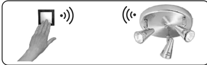
Der Sender für die Montage in der Unterputzdose. Er verfügt über die autonome Batterienversorgung. Dadurch kann man über keine Versorgungsleitungen an der Stelle der Tastenmontage verfügen. Für die Steuerung kann man monostabile (zeitweilige) Tasten der beliebigen Serie der Elektroninstallationsgeräte benutzen.
