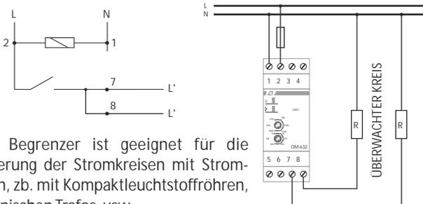
Dieser Begrenzer ist geeignet für die Absicherung der Stromkreisen mit Stromrichtern, zb. mit Kompaktleuchtstoffröhren, Elektronischen Trafos, usw.
