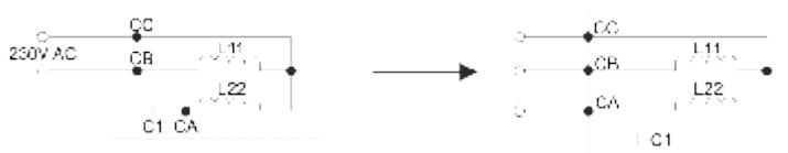
Typisches Schema des Motors mit einer Phase mit dem Anlaßkondensator
